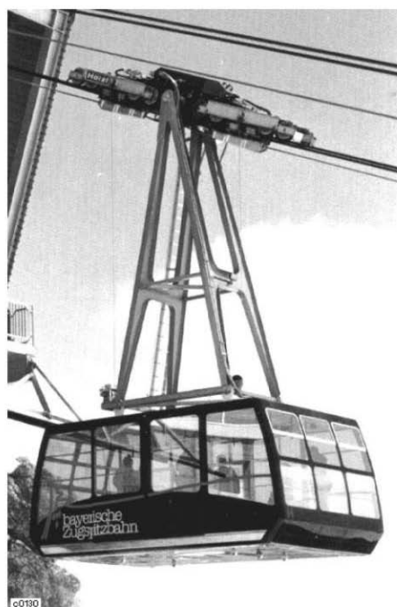
Izvedba za žičnico brez podpornih stebrov
