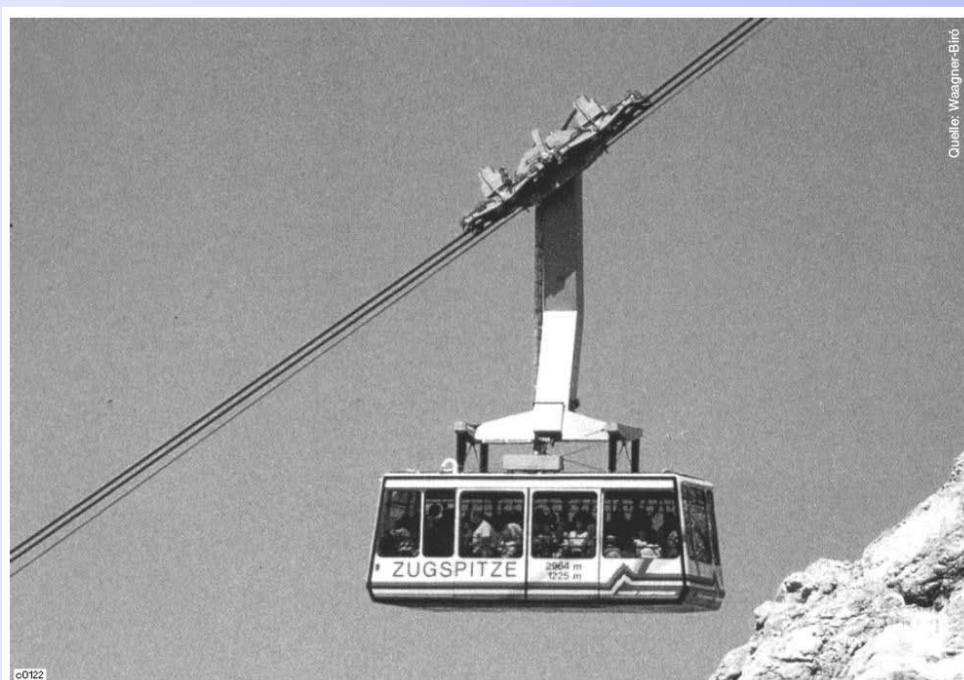
Dvovrvna nihajna žičnica s kabino za 100 oseb
